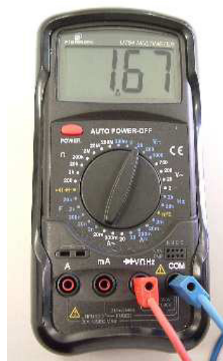
Flussspannung der roten LED
