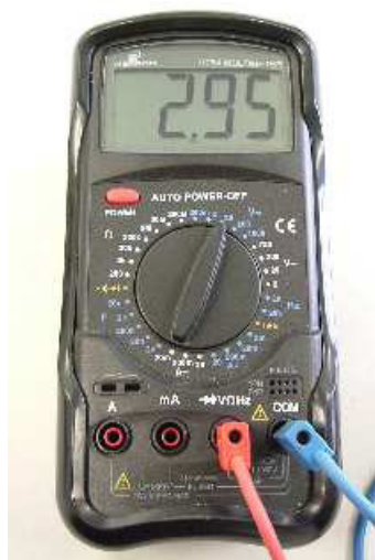
Flussspannung der blauen LED
